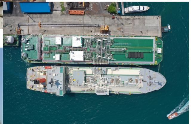
Terminal LNG Bena yang dioperasikan Pelindo Energi Logistik merupakan terminal penerimaan LNG skala mini pertama di Indonesia. Terminal ini memiliki fasilitas LNG Carrier, Floating Storage Unit, Floating Regasification Unit serta Port and Pipe Facility.
